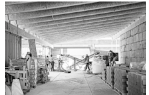
Production of clay bricks as a direct replacement of inner masonry blocks such as fast bricks, sand-lime bricks, concrete blocks/ Productie van leemstenen als directe vervanging van binnenmetselwerkblokken zoals snelbouwsteen, kalkzandsteen, betonblokken
