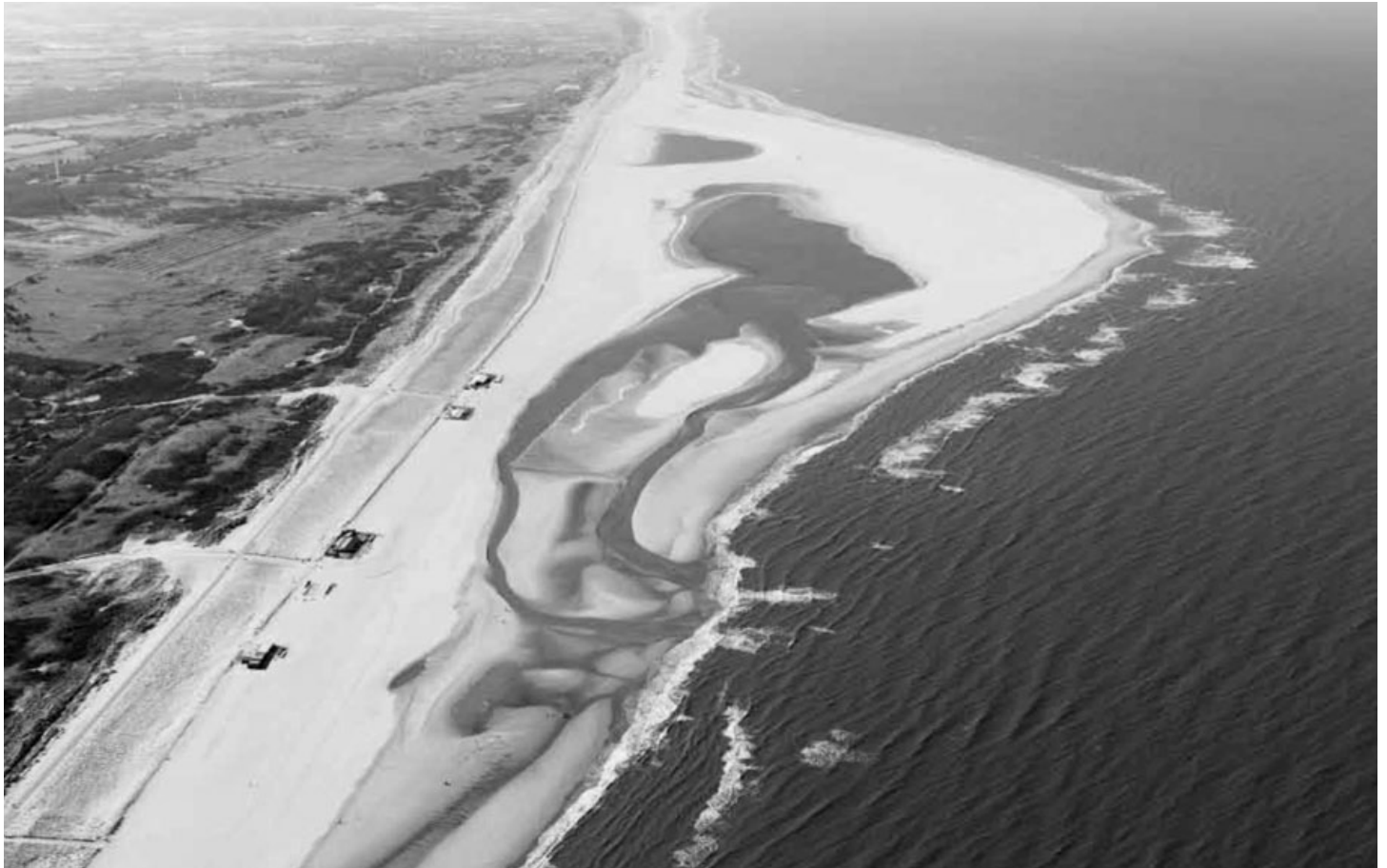
Constructing with natural elements: the 'sand motor' for the coast between the Hook of Holland and The Hague, 2012 / Bouwen met de natuur: De 'zandmotor' voor de kust tussen Hoek van Holland en Den Haag, 2012
